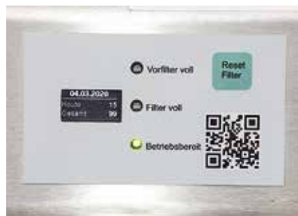
Die mit WLAN ausgestattete Steuerung dokumentiert jeden Kastrationsvorgang.
