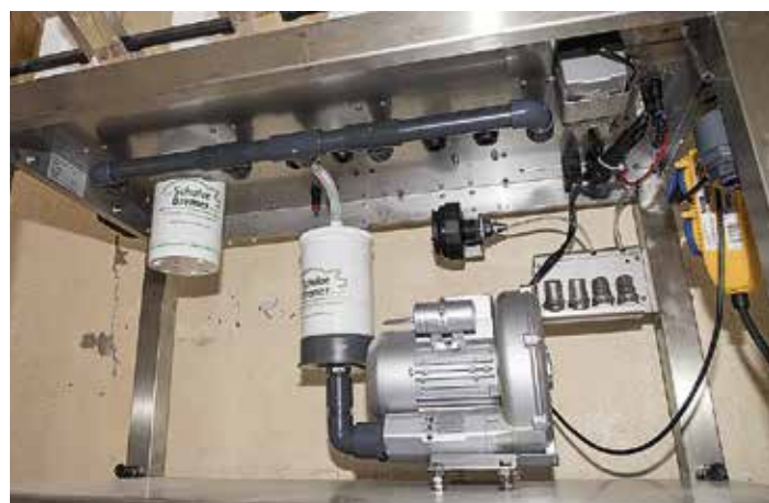
Abgesaugt wird das Gas von einem in der unteren Etage platzierten Gebläse. Die beiden Aktivkohlefilter (Kunststoffbehälter) sammeln das abgesaugte Isofluran gemäß Prüfung nahezu vollständig.
