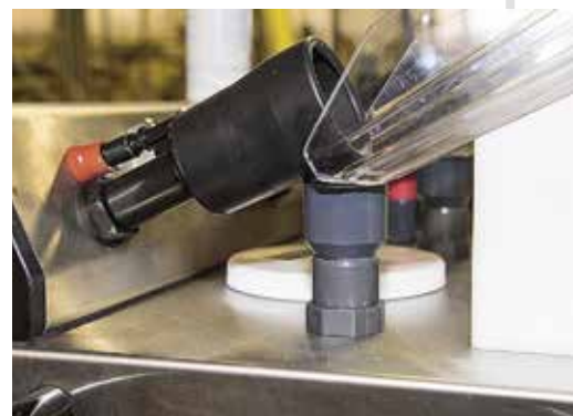
Das senkrecht stehende Rohr trägt wesentlich zum sehr guten MAK-Wert des Geräts bei.
