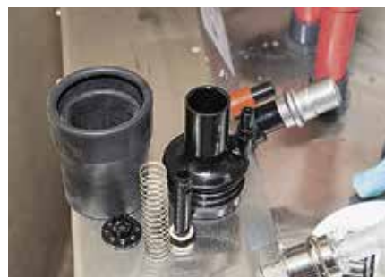
Die Doppelatemmasken lassen sich zum Reinigen binnen Sekunden werkzeuglos zerlegen.
