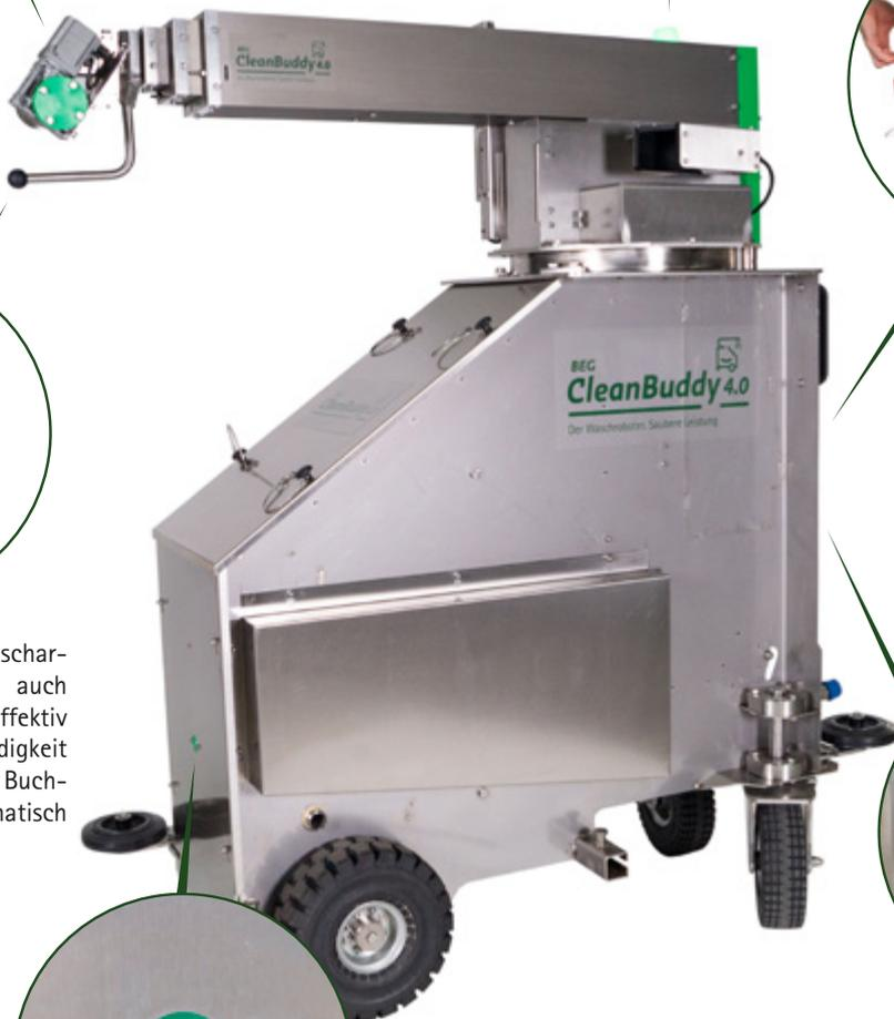
Die Düse arbeitet mit einem scharfen Punktstrahl, so werden auch entfernte Schmutzpartikel effektiv beseitigt. Die Drehgeschwindigkeit der Düse passt sich je nach Buchtiefe und Armlänge automatisch an.
